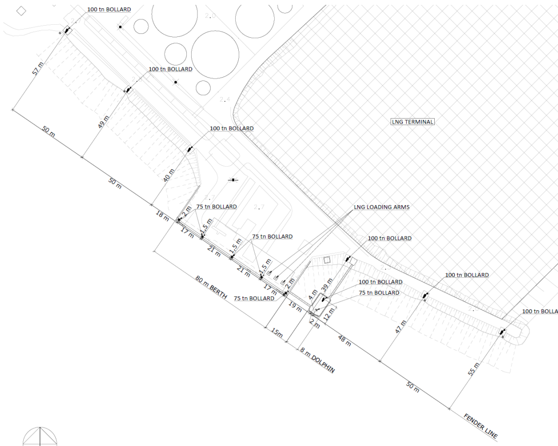
Kuva 1: Öljylaituri numero 3a Haminan satamassa. / Picture 1. Oil pier number 3 at the port of Hamina.
